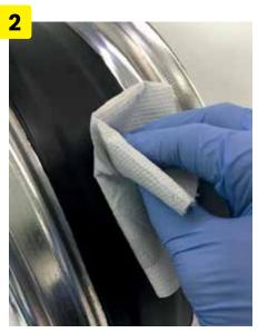
Pulire accuratamente l'area intorno al nipplo da sostituire con un comune diluente nitro.
