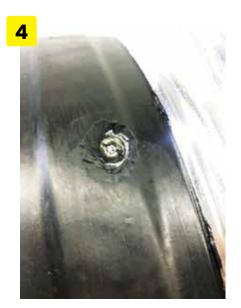
Rimuovere il materiale fino ad esporre normalmente. Quindi, sostituire il raggio o il nipplo normalmente.
